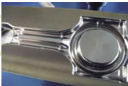
La lavorazione di una biella sul centro di lavoro a 5 assi Spinner DMH-0706
